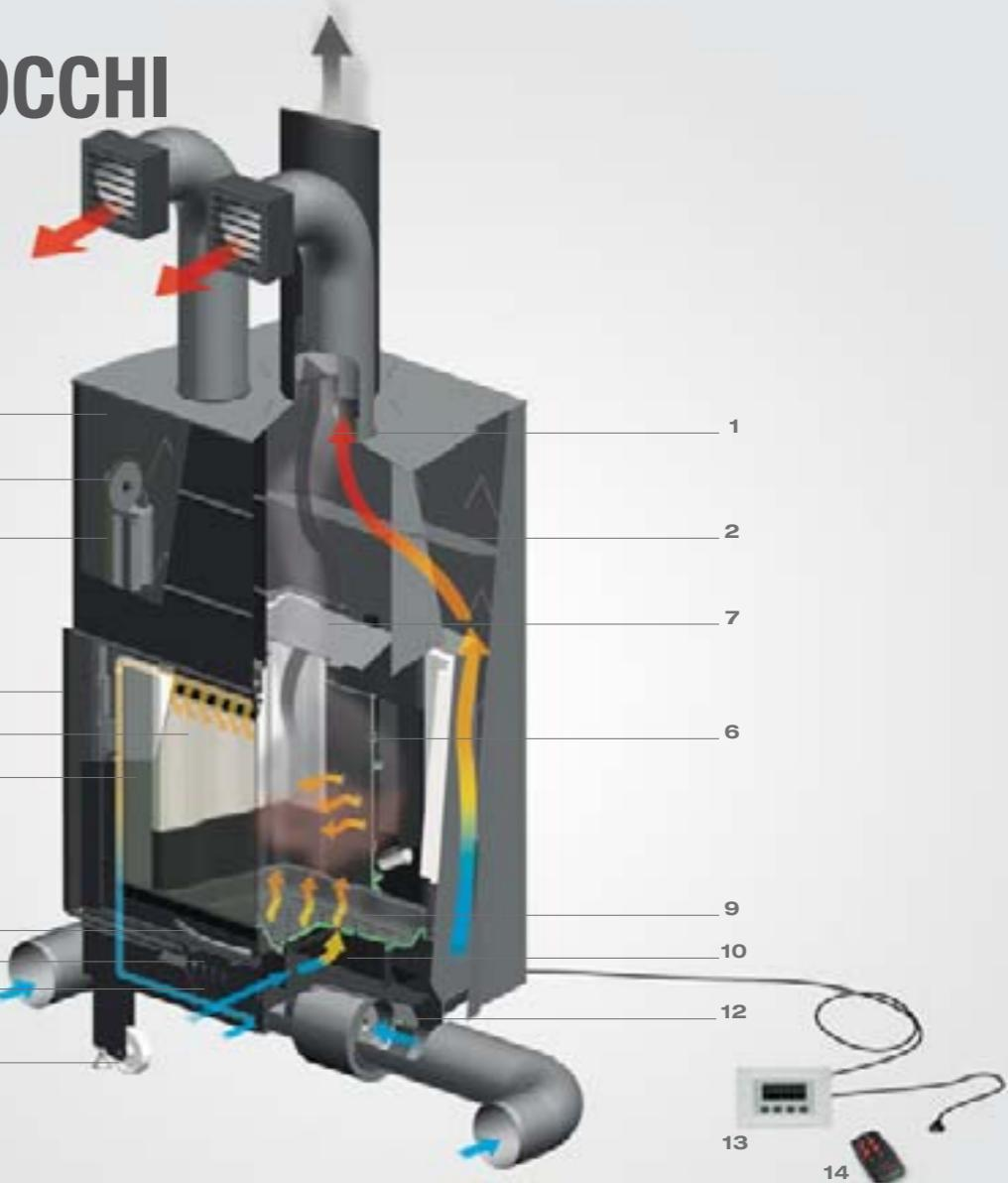
1 N. 4 uscite aria calda Ø 150 mm • 4 hot air outputs Ø 150 mm • Nr.4 sorties air chaude Ø 150 mm • N.4 Warmluftauslässe Ø 150 mm • Núm. 4 salidas aire caliente Ø 150 mm.
